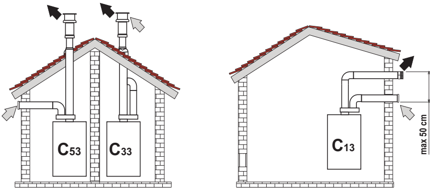
fig. 25 - Esempi di collegamento con tubi separati
