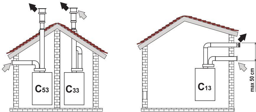
fig. 25- Exemple de racordare cu tuburi separate
